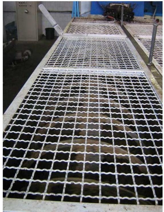
Aus diesem Behälter (blau im Hintergrund der Aufnahme) fließt die Paste in die „Schnecke“. Durch das in die Zwischenwände der Spirale hinzugefügte und beständig zirkulierende Wasser wird die Paste in einer gleichbleibenden Temperatur von maximal 28° gehalten.
