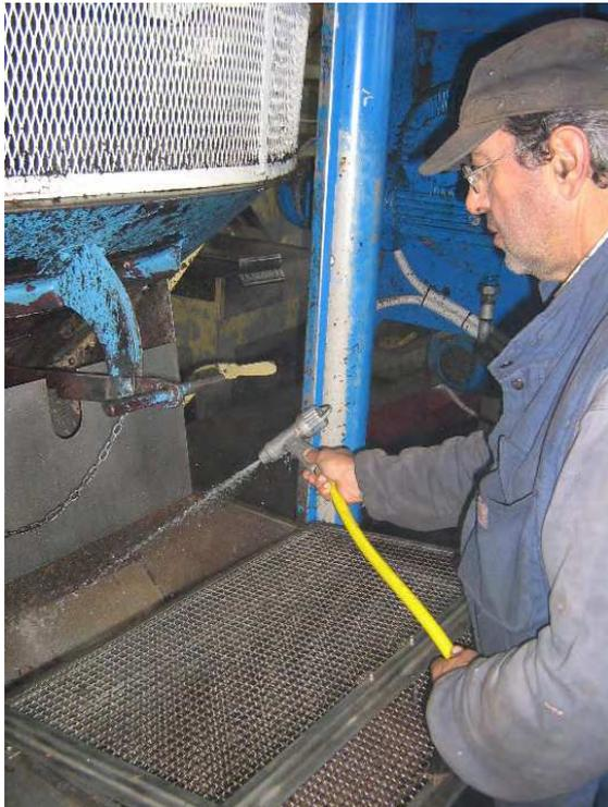
Von der Steinmühle kommt die Olivenpaste zur Regelung der Temperatur in diesen Behälter. Es kann der Olivenpaste eventuell kaltes oder gewärmtes Wasser zugegeben werden. Die Temperatur des hinzugefügten Wassers hängt von der jeweiligen Raumtemperatur in der Ölmühle ab. In der Regel hat die Paste zwischen 20 und 28 °. Außerdem muss die Paste von den Wänden abgespült werden und für den Weitertransport weich genug sein.
