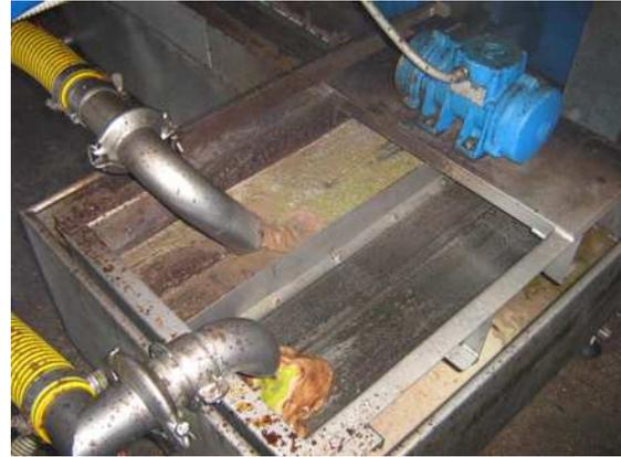
Nach dem „Separatore“ (Entmischer – ohne Aufnahme), der Trennung von Öl, Wasser und der Pressrückstand (z.B. Kerne) tritt das Öl und das Wasser aus unterschiedlichen Röhren aus. Links wird das Öl weitergeleitet, in der Mitte fließt das Wasser ab. Ganz oben wird der Pressrückstand abgesaugt und vor die Ölmühle transportiert (siehe unten).
