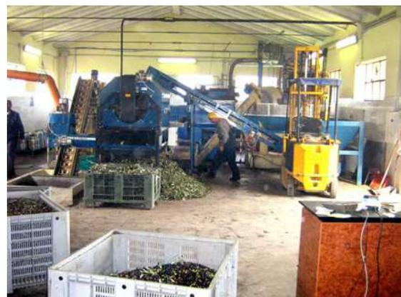
Der Innenraum der Mühle - rechts hinter dem Gabelstapler der erste Auffangbehälter und dahinter die Steinmühle, links die Trommel zur Aussortierung von Blättern und Zweigen
