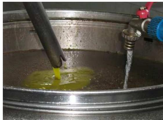
Ein letztes Mal wird etwas Wasser zugegeben, um den Durchfluss zu regeln. Dabei werden durch das austretende Wasser kleinere unsaubere Beimischungen im Öl ausgeschwemmt.
