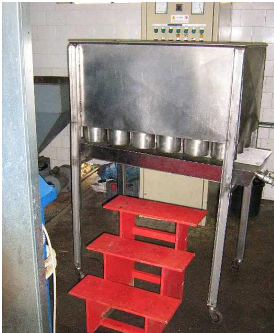
In diesem Behälter kann auf Wunsch des Kunden das Öl zusätzlich gefiltert und von Schwebestoffen befreit werden. Dazu läuft es durch ein feines Baumwollgewebe. Es wird dabei keinerlei Druck auf das Olivenöl ausgeübt.
