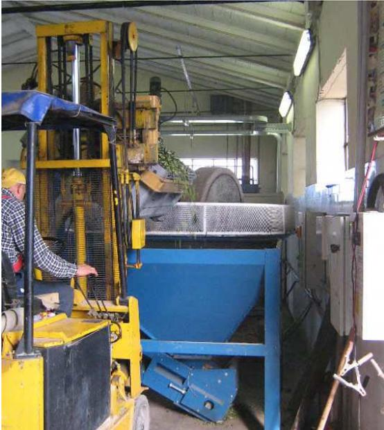
Ein Korb mit Oliven wird mit dem Gabelstapler in den ersten Auffangbehälter geschüttet.
